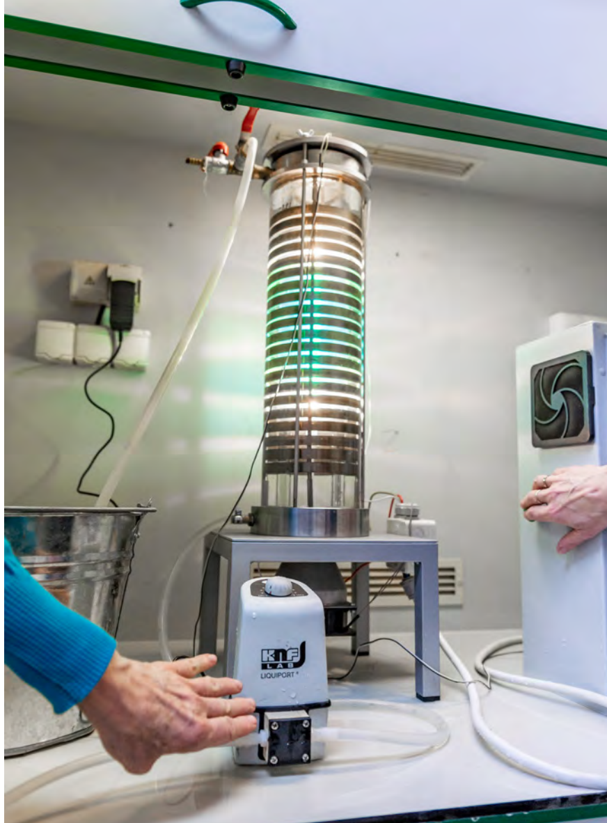
Zařízení, které využívá fotokatalytických postupů pro odstraňování endokrinních disruptorů z odpadních vod, vytvořili v Ústavu chemických procesů AV ČR.
