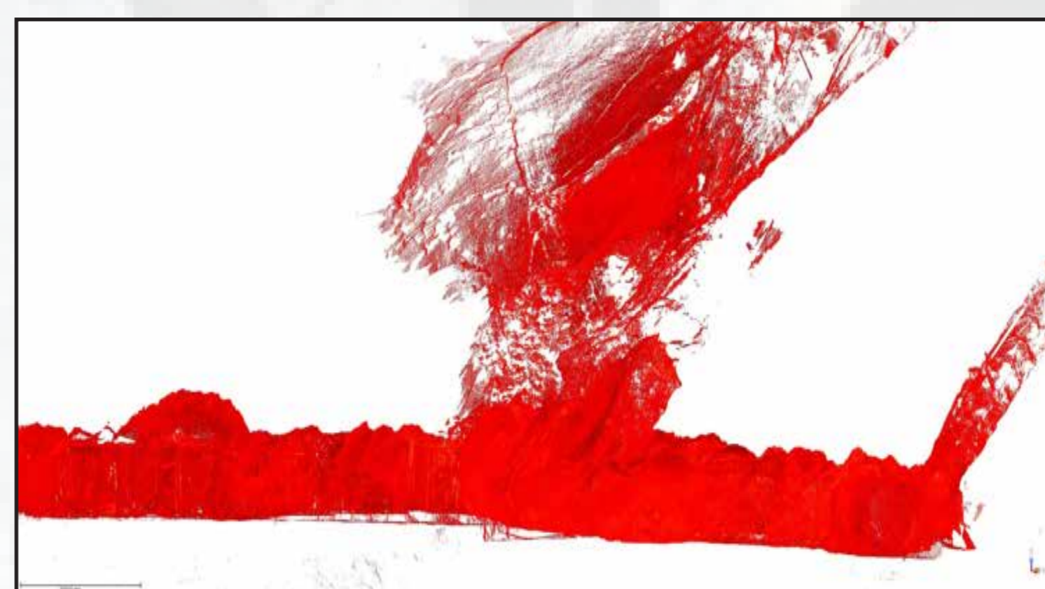
Typický výstup ze 3D skeneru v podobě mračna bodů
