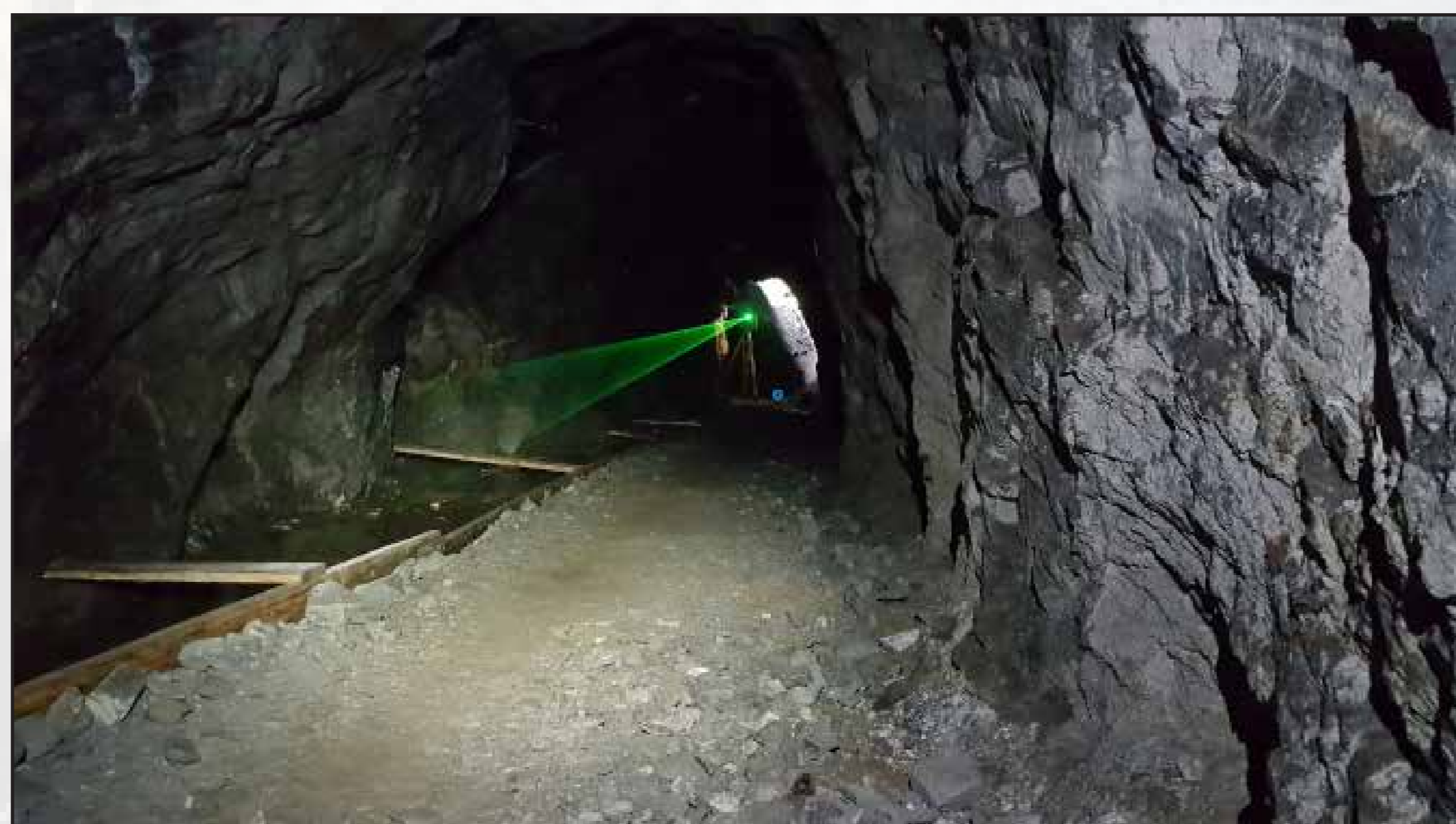
Laserový paprsek o vlnové délce 532 nm, třída 3R
