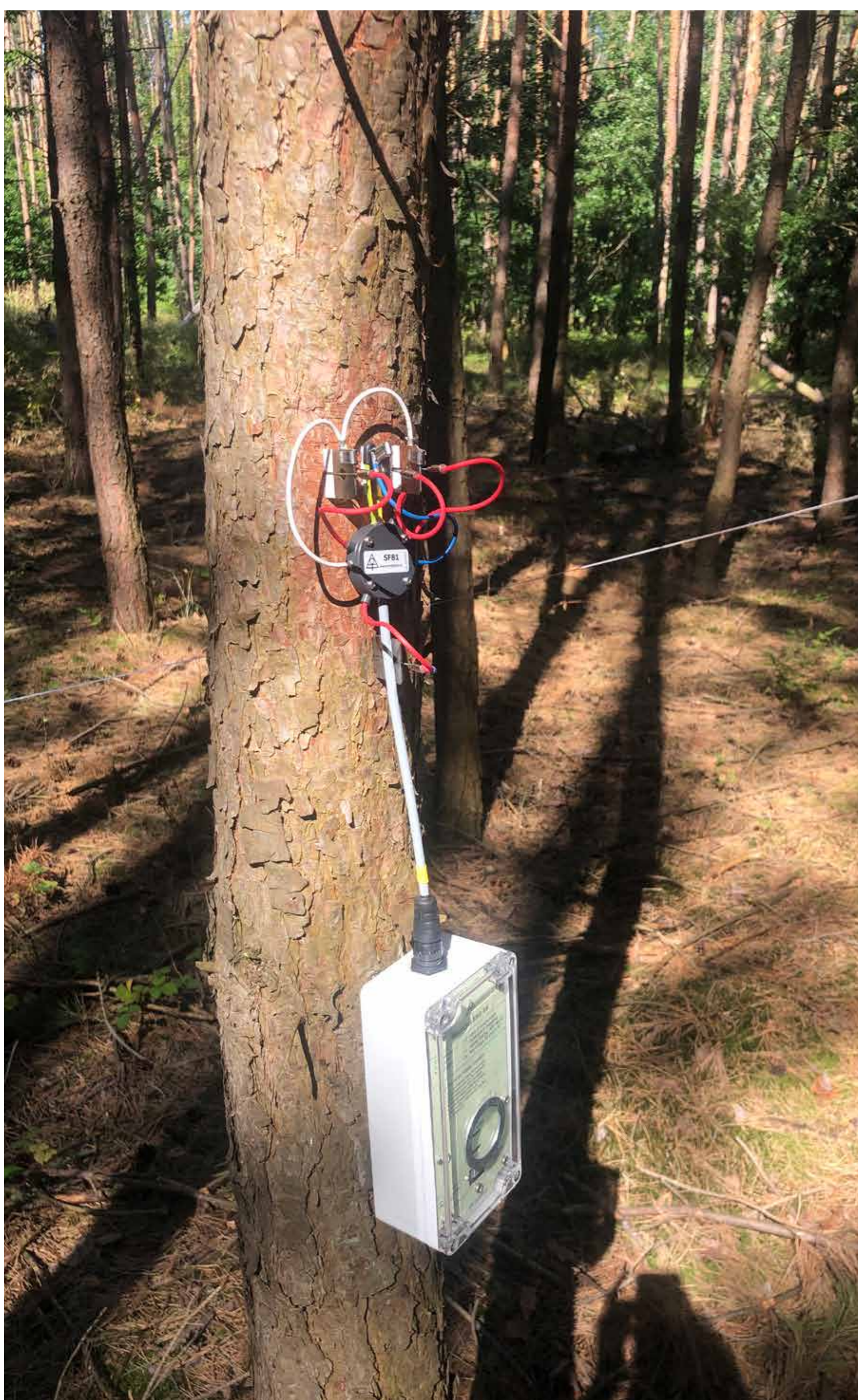
Čidlo pro stanovení intenzity mízního toku, tj. spotřeby vody stromem.
