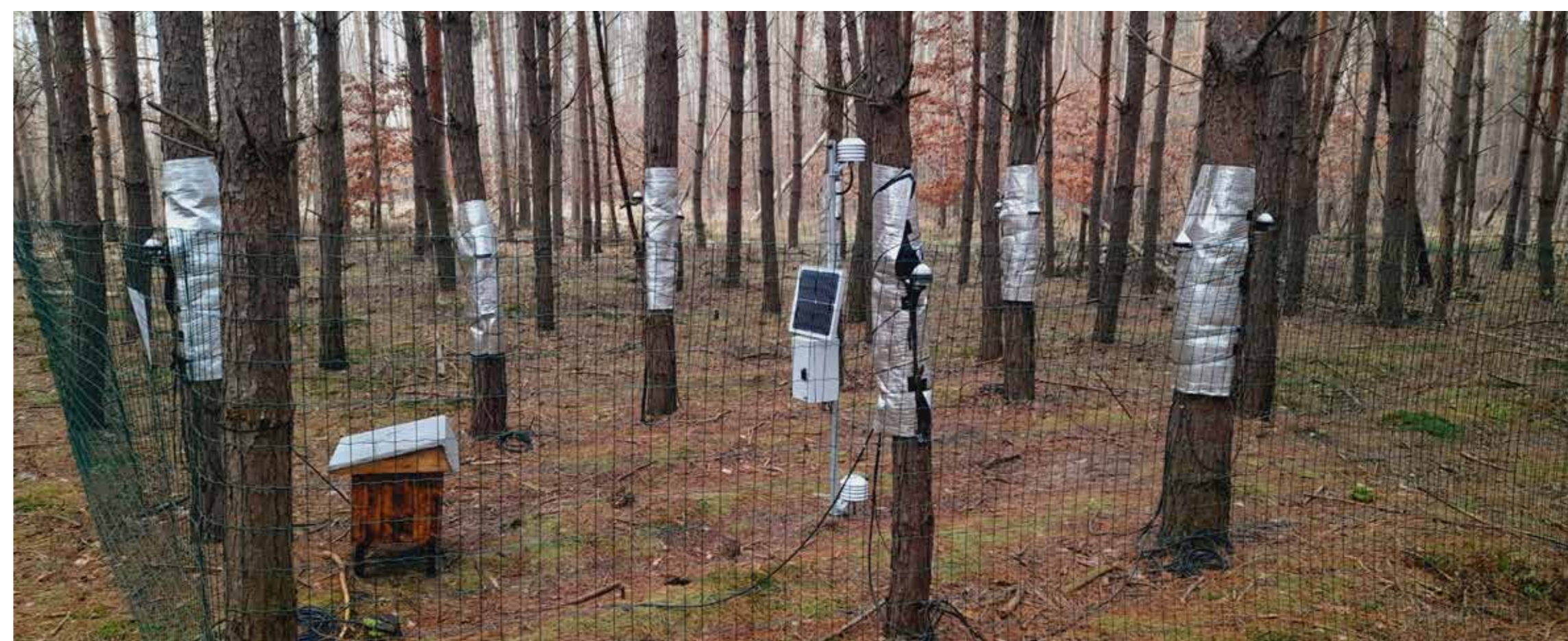
Stanice pro měření výparu v lesním porostu, obec Velký Osek.
